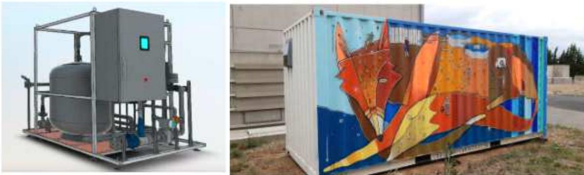
**La Reut BOX** est composée d'un filtre garni de billes de verre, d'une désinfection UV et d'une chloration avant stockage, La Reut Box a un faible encombrement au sol sur site. C'est une solution intégralement automatisée avec un minimum d'exploitation. Solution modulaire et évolutive qui permet de s'adapter au besoin.
